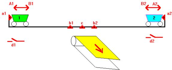
Cahier des charges : Dans une mine, deux mineurs sont au fond de leur veine respective et disposent chacun d'un chariot motorisé. Le mineur remplit son chariot, puis l'envoie vers un poste de déchargement commun, où il sera automatiquement déchargé, puis le chariot retournera (toujours d'où il est parti). Les deux voies sont distinctes, sauf au niveau du poste de déchargement
