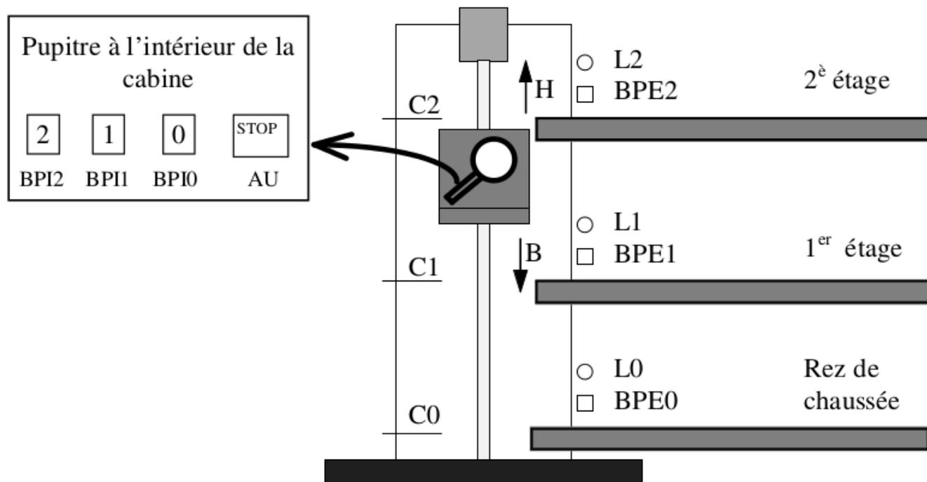
**Entrées du système :** AU : bouton d'arrêt d'urgence. BPI0, BPI1, BPI2 : boutons poussoirs intérieurs à la cabine servant à sélectionner un étage . BPE0, BPE1, BPE2 : boutons poussoirs situés aux différents étages et servant à appeler la cabine. C0, C1, C2 position de la cabine aux différents étages.
